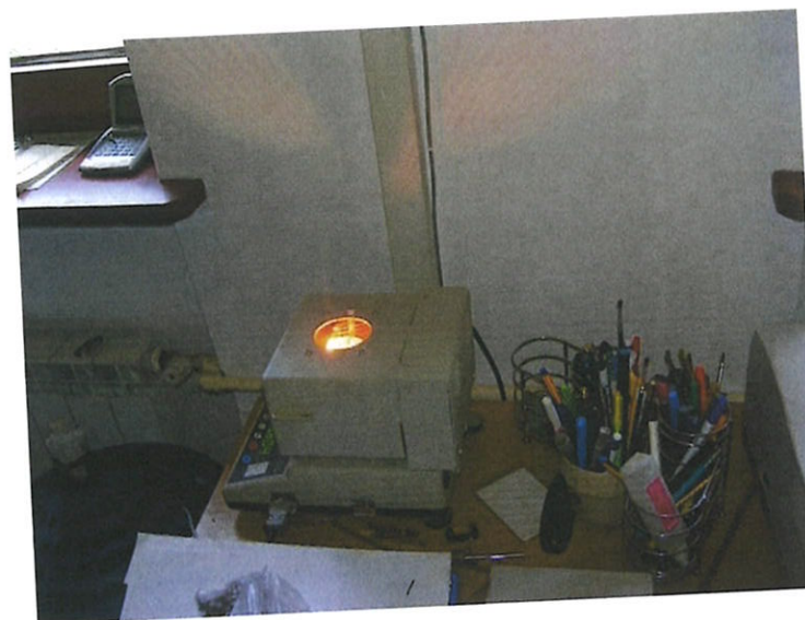
Pomiar wilgotności ściółki wagosuszarką
